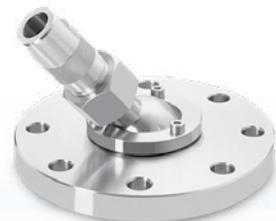
可调节球形旋转法兰使喷嘴转台的位置能够快速调节，清洗螺带混合器的叶片，因此能将清洗效果最大化。
