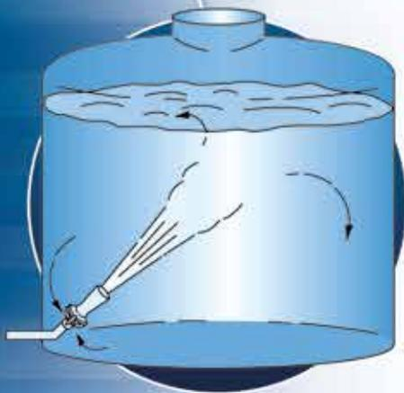
圆柱形槽罐内的混合
