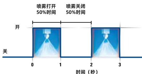
**AutoJet 1550+ 精确喷涂系统**提供全自动的喷嘴喷雾控制，以确保在最大限度减少浪费的情况下，精准喷涂脱模剂。
