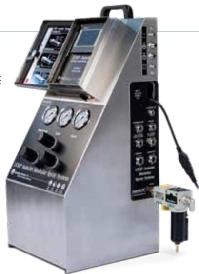
**精确喷雾控制 (PSC)** 可快速开关喷嘴，以控制流量。打开和关闭的循环间隔非常短，以至于流量往往看起来是恒定的。对于传统喷嘴，流量调节需要改变液体压力，这就会改变喷嘴的喷雾角度、覆盖范围和液滴尺寸。有了精确喷雾控制，其压力保持恒定，允许在不改变喷雾性能的情况下改变流量。精确喷雾控制需要使用电动喷嘴和一个AutoJet喷雾控制器。
