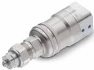
电动喷嘴能提供持续喷洒，每分钟最多可动作2000次。所有的接头均位于喷嘴后部，以减小喷嘴尺寸。因为有一个快速更换磨损部件的流体模块，所以在维护期间，其安装和连接不会受到干扰。
