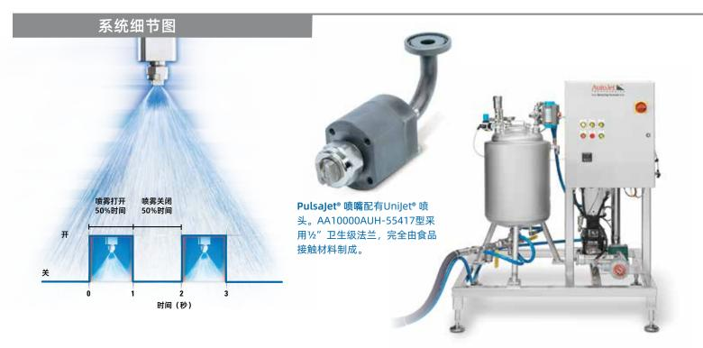
精确喷雾控制(PSC)涉及快速开关喷嘴,以控制流量。打开和关闭的循环间隔非常短,以至于流量往往看起来是恒定的。对于传统喷嘴,流量调节需要改变液体压力,这就会改变喷嘴的喷雾角度、覆盖范围和液滴尺寸。有了精确喷雾控制,其压力保持恒定,允许在不改变喷雾性能的情况下改变流量。PSC需要使用电动喷嘴和一个AutoJet®喷雾控制器。
