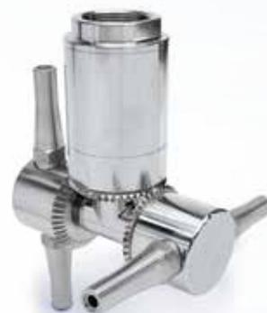
**TankJet 65-HT**, 全不锈钢槽罐清洗器,配有四个多轴旋转液注流喷嘴,每45转可提供360°完全覆盖整个槽罐。整套单元独具自清洗直通式设计,易于维护。
