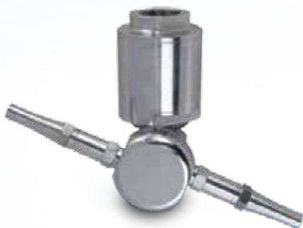
**TankJet 80**, 可配置两个或三个液注流喷嘴，为高达15.2米的槽罐提供强大、可靠的清洗。缓慢的360°旋转喷嘴提供在槽罐表面极佳的停留时间，同时确保高效的清洗效率。
