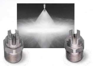
WashJet喷嘴(图左)具有强大的清洁性能。这些喷嘴能够产生高打击力的喷射,最大工作压力达3000psi(207巴)。VeeJet喷嘴(图右)为锥形扁平设计,通常安装在喷雾集管上。喷射区域重合保证了均匀的覆盖面,当板材从集管下经过时能够彻底冲洗整块板材。
