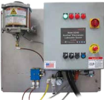
正在申请专利的52200型AutoJet静电润滑系统在改善链条润滑的同时，还大大降低了油耗和缩短了传送装置的停机时间。该系统围绕一个AutoJet喷雾控制器、静电喷嘴、一个16升（4.2加仑）油箱和一个压力调节器/过滤器/压力开关进行构建。该系统提供系统参数的实时监控，包括自动警告和报警功能。
