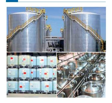
减少用水的简便方法之一是改变您清洁工厂的水箱、混合 器、搅拌机和其它设备。如果工人手动或使用充水和排水 方法清洗水箱,那么自动化每年能节省千百万升的水。如 果已在使用自动化设备,请参详另外一种选择。也可能有 新的设备能大大减少用水。
