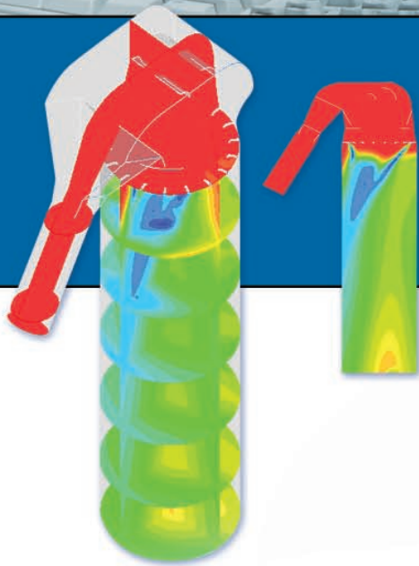
温度曲线图，表示塔内通过 FloMax® 空气雾化喷嘴进行的气体冷却。
