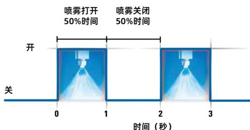
精确喷雾控制 (PSC) 可快速开关喷嘴，以控制流量。打开和关闭的循环间隔非常短，以至于流量往往看起来是连续的。对于传统喷嘴，调节流量需要改变液体压力，这就会改变喷嘴的喷雾角度、覆盖范围和液滴尺寸。对于PSC，其压力保持恒定，允许在不改变喷雾性能的情况下改变流量。PSC需要使用电动喷嘴和一个AutoJet喷雾控制器。
